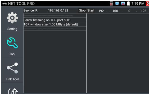
b). **Starten Sie den Paketttest:** Geben Sie mit dem anderen IP-Tester die IP-Adresse des Servers in der oberen rechten Ecke des Bildschirms ein. Diese App wird zum Senden von Paketen für den Test der Netzwerkgeschwindigkeit verwendet. Klicken Sie auf die Schaltfläche "Start", um die Pakete zu senden und den Test zu starten.
