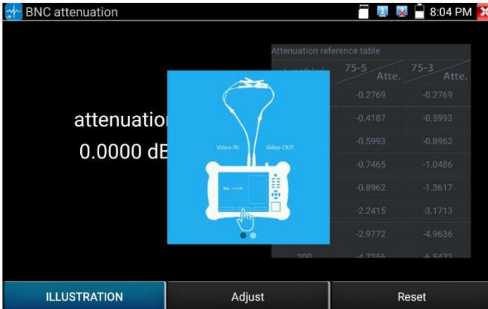
Nach der Kalibrierung klemmt die rote Klemme den Kupferkern des BNC-Kabels und die schwarze Klemme die äußere Umhüllung des BNC-Kabels ab. nach dem Anschluss wird der Dämpfungswert wie unten dargestellt angezeigt:
