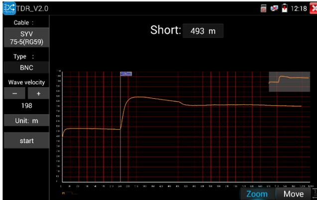
Abstandsleiste: Zeigen Sie die aktuelle Länge an, und verwenden Sie die virtuelle Tastatur, um den Abstandsbalken zu verschieben.
