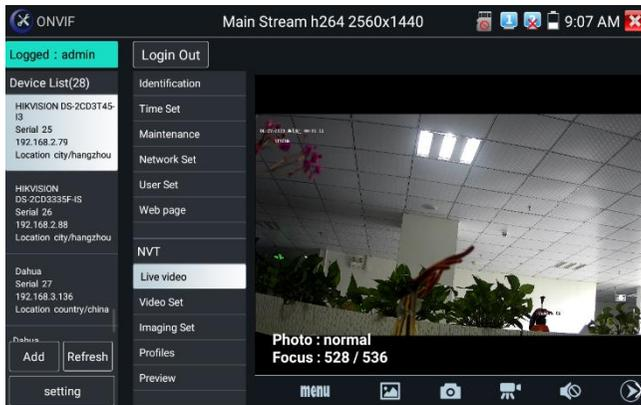
**ONVIF-PTZ-Steuerung:** Tippen Sie auf das Bild in die Richtung, in die Sie die PTZ-Kamera bewegen möchten. Tippen Sie auf die linke Seite des Bildes, um nach links zu gehen, nach rechts, um nach rechts zu gehen, nach oben, um nach oben zu gehen und nach unten, um nach unten zu gehen. Kompatible IP-PTZ-Kameras werden entsprechend gedreht. Die PTZ-Drehrichtung wird in der oberen linken Ecke des Bildes angezeigt.
