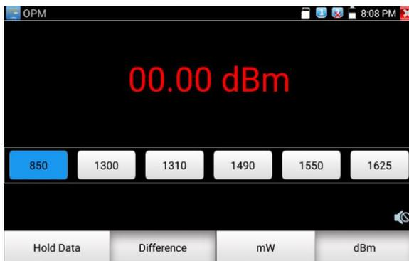
Bei gleichzeitiger Verwendung von Data Hold und Relativmessung werden die Daten gelb angezeigt, während die Funktion wirksam ist.
