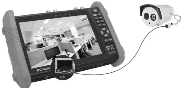
**Hinweis:** 1) Wenn die IP-Kamera PoE-Strom benötigt, schließen Sie die IP-Kamera an den LAN-Anschluss des IP-Testers an. Das Prüfgerät liefert PoE-Strom für die IP-Kamera. Klicken Sie auf das Symbol POE, um die PoE-Stromversorgung ein- oder auszuschalten.
