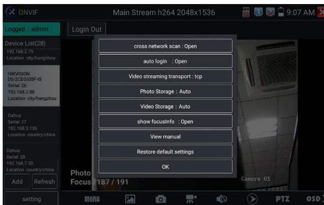
**Netzwerkübergreifender Scan:** Nachdem Sie diese Funktion geöffnet haben, geben Sie "Einstellung - IP-Einstellungen - Erweitert" ein, um die IP anderer Netzwerksegmente hinzuzufügen. Die Rapid ONVIF-Funktion kann über Netzwerksegmente hinweg die IP der Kamera scannen.
