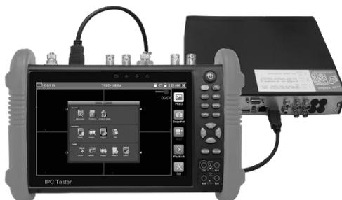
Verbinden Sie den HDMI-Ausgang des DVR oder eines anderen Geräts mit dem HDMI-Eingang des Messgeräts, das Messgerät zeigt das Eingangsbild an.
