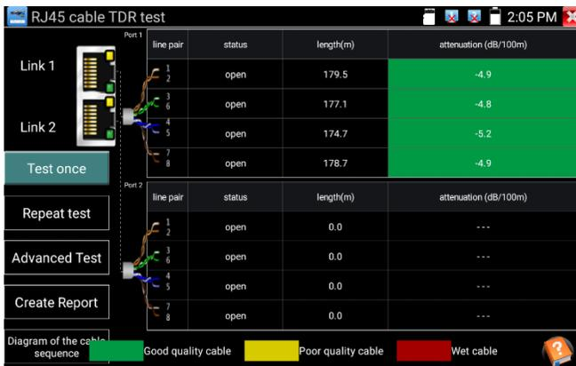
**Einzeltest:** Prüfung von Kabelzustand, Länge und Dämpfung.
